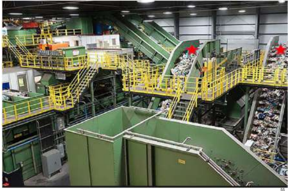
กลางน้ำวิธีการแยกขยะที่เมือง New York มีรูปร่างและลักษณะ เป็นอย่างไร มีจำนวนมากเท่าไร? (สายพานแยก ขยะ Plastics )
